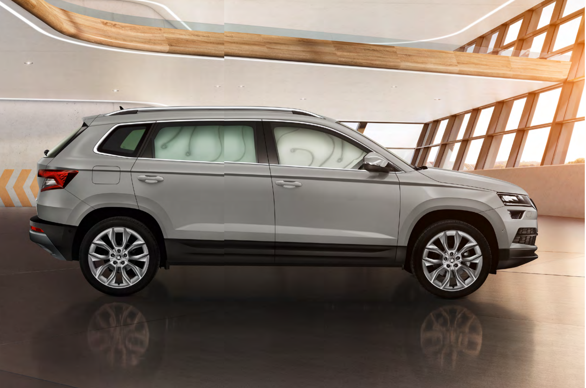
HLAVOVÉ AIRBAGY Keď sa hlavové airbagy aktivujú, vytvoria stenu, ktorá chráni cestujúcich pred zranením hlavy.
