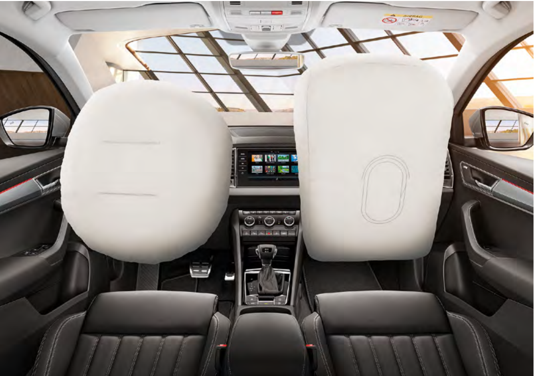
PREDNÉ AIRBAGY Airbag vodiča je uložený vo volante, airbag spolujazdca je v prístrojovom paneli. Ak je na prednom sedadle namontovaná detská sedačka, dá sa jednoducho deaktivovať.
